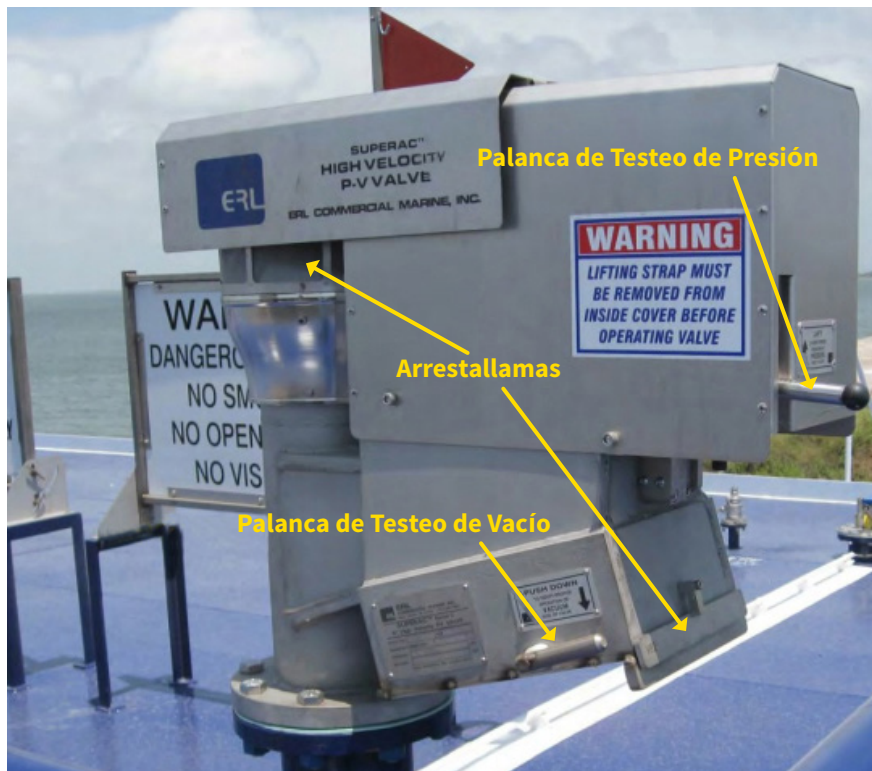
Fig 10: Válvula 'P/V Hi-Jet'
